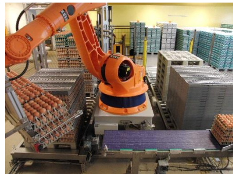
Robotiklösung zur Eierpalettierung (Quelle: emt automation GmbH)
